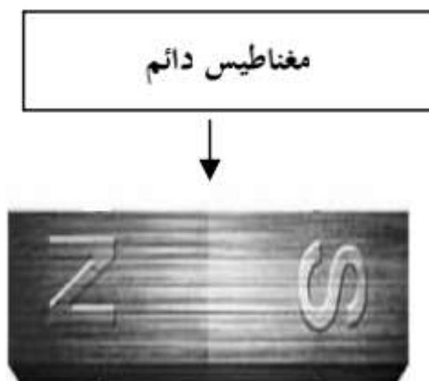
تولد مغناطيسية المغناطيسي الدائم بنفس طريقة التي تولدت في المسمار لكن بسبب التركيب الجهري لمادة المغناطيسي فإن المغناطيسية تصبح دائمة.
